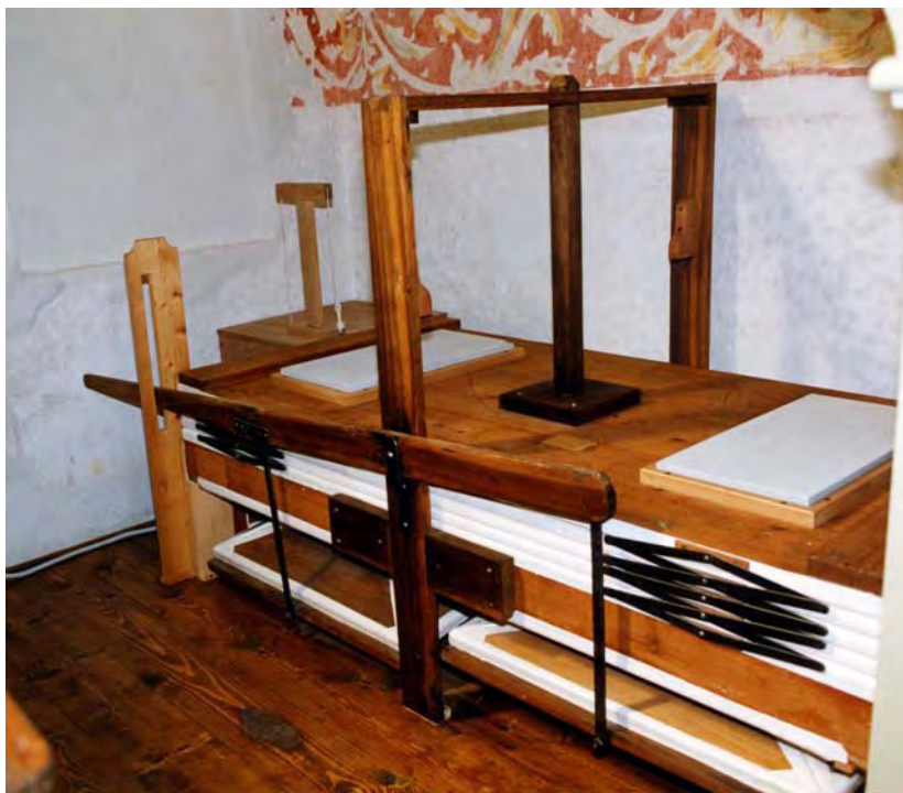
Foto 4 – Il mantice “a lanterna” sostituito dal De Lorenzi nel 1864
